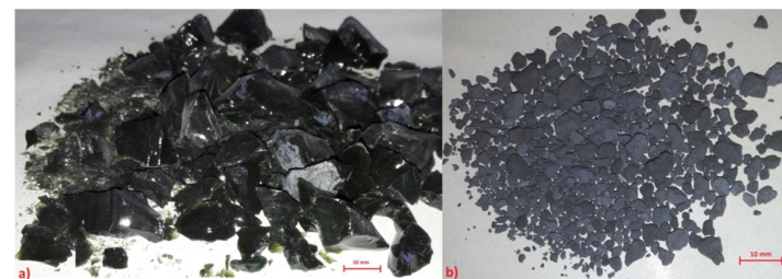
Fig. 2: Samples of slags: a) FeCr/FeSiMn slag; b) EAF slag
