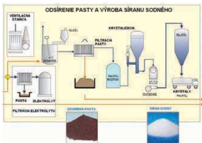
Obr. 6: Postup odsírenia pasty a výroba síranu sodného
