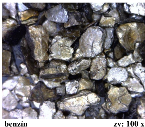
Obr. 7 Detailný pohľad trblietavé častice vnútra katalyzátora
