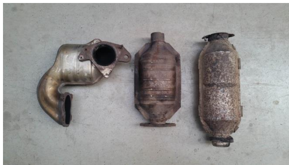
Obr. 4 Autokatalyzátory pre experimenty
