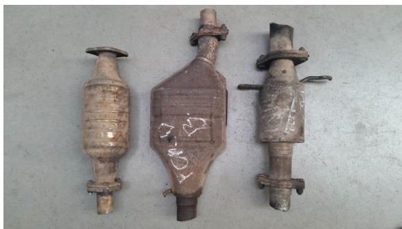
Obr. 4 Autokatalyzátory pre experimenty
