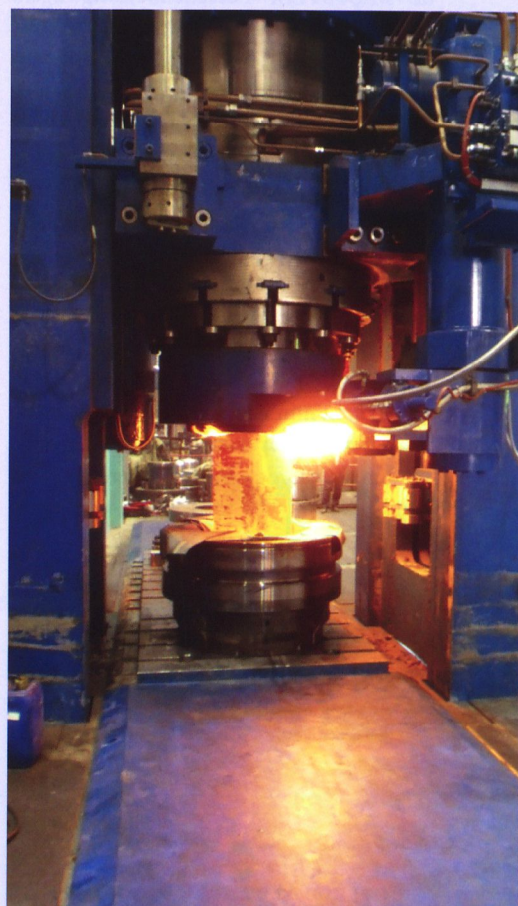
Ringrohlingpresse PL 8000-V3 mit einer Presskraft von 8.000 Tonnen
