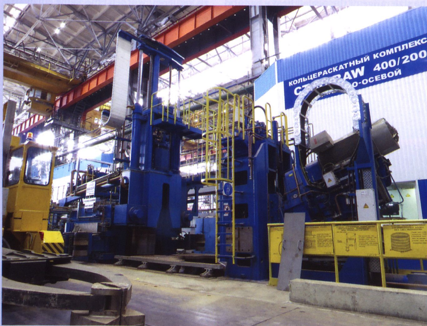
Radial-Axial-Ringwalzmaschine RAW 400/200 DM zum Ringwalzen von Superlegierungen, Titan- und Aluminiumlegierungen sowie rostfreiem Stahl
