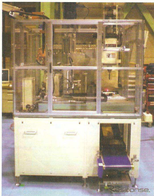
Obr. 6: Zariadenie na demontáž klimatizačných zariadení v spoločnosti Mitsubishi Electric [18]
