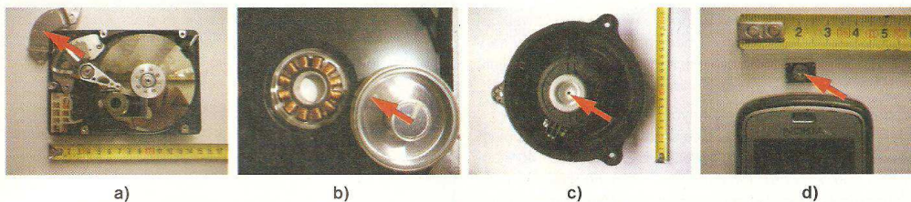
Obr. 3: Umístění Nd-Fe-B magnetů v různých částech elektronického odpadu; a) svařený Nd-Fe-B magnet z pevného disku; b) polymérově vázaný Nd-Fe-B magnet z pevného disku; c) Nd-Fe-B magnet z reproduktora automobilu; d) Nd-Fe-B magnet z reproduktora mobilního telefonu
