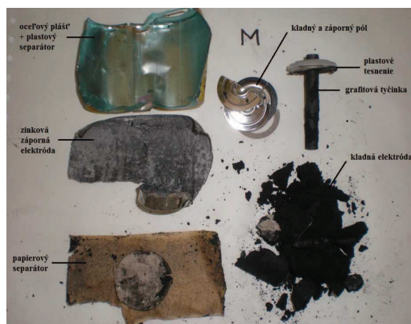
Obr. 2 Zn – C batéria po ručnej demontáži
