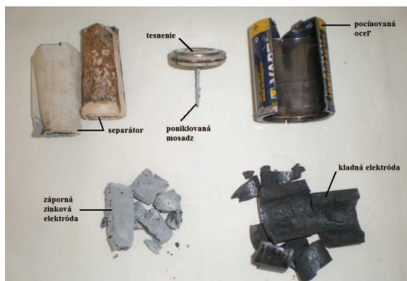
Obr.4 Alkalická batéria po ručnej demontáži
