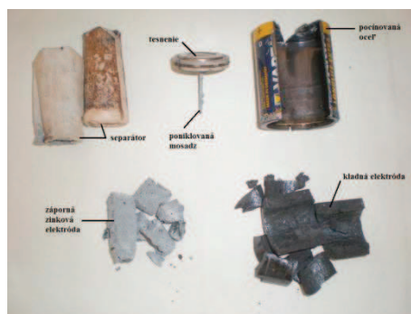
Obr. 4 Alkalická batéria po ručnej demontáži
